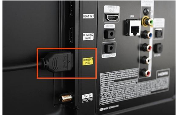
Pemasangan Kabel HDMI pada TV
