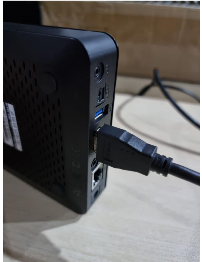
Pemasangan Kabel HDMI pada STB
