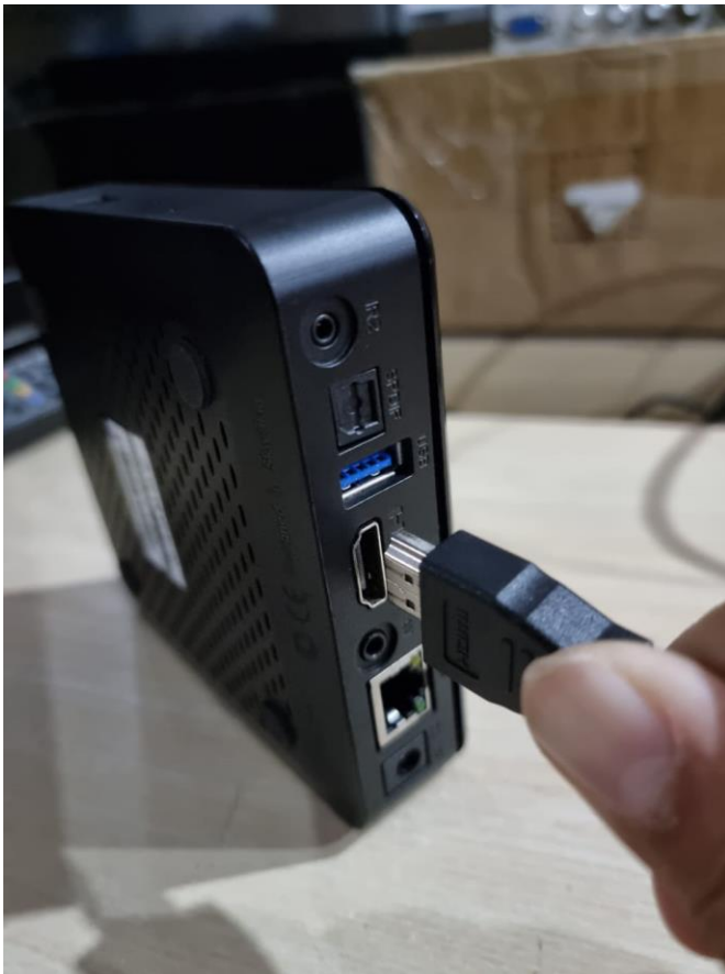
Pemasangan Kabel HDMI pada STB
