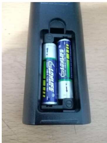
Pemasangan Baterai terbalik
