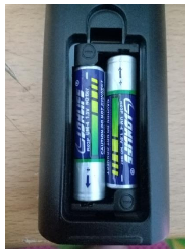
Pemasangan Baterai Benar
