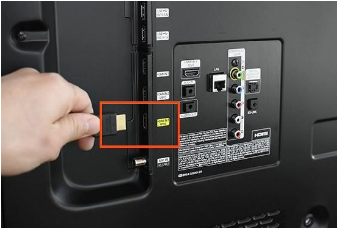
Pemasangan Kabel HDMI pada TV
